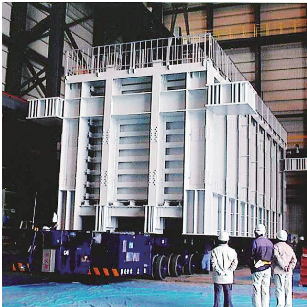
地盤実験用治具製作
