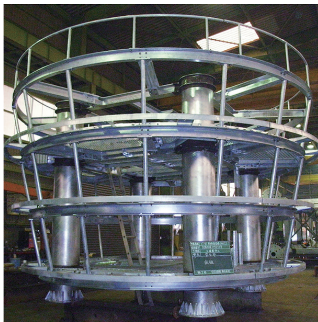
照明鉄塔製作
